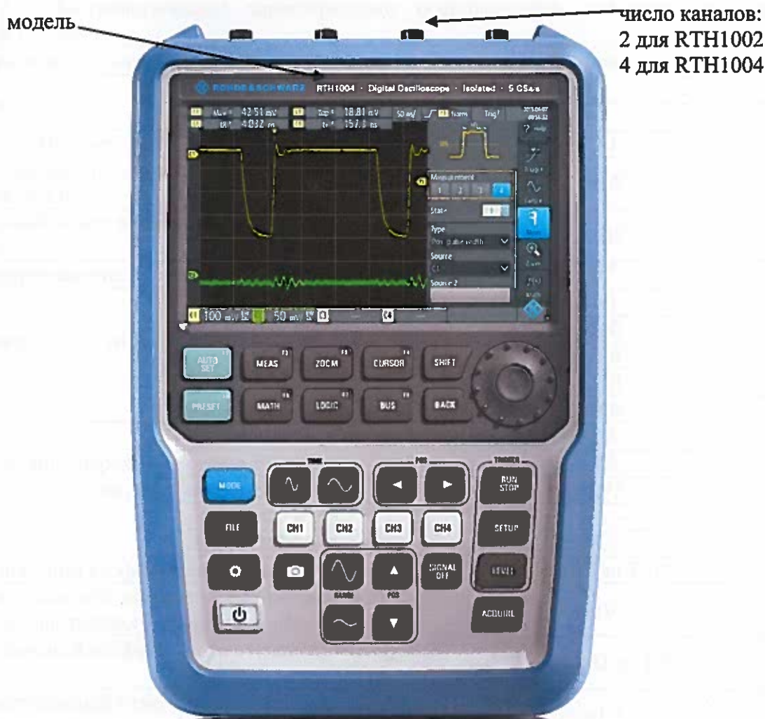
Рисунок 1 - Внешний вид осциллографов цифровых портативных RTH1002, RTH1004
